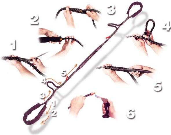
1. インサート板(エキスパンション・インサート)の差し込み。
